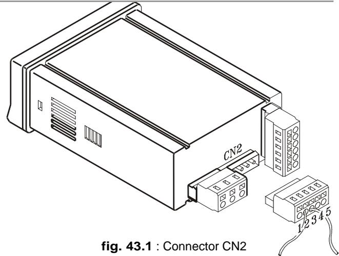
fig. 43.1 : Connector CN2
