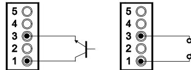
fig. 43.2 : Wiring examples.
