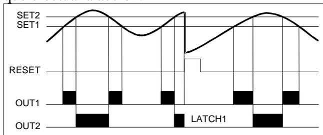
3. En la configuración LATCH2 el relé desactivado queda permanentemente en este estado. Sólo podrá volver a activarse, si corresponde, en un reset que desenclave el relé que efectúa la acción.
