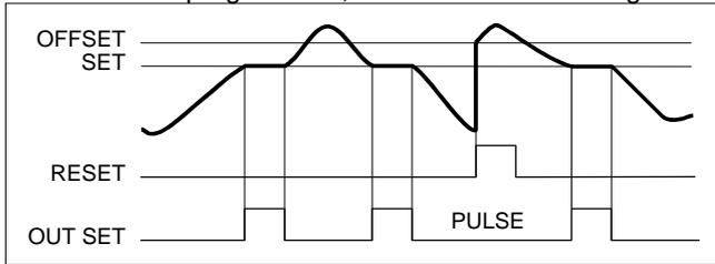
2. In LATCH1 y LATCH2 mode se para el contador definitivamente y sólo reanuda la marcha cuando se realiza un reset del contador. El contador arranca en el valor cero de offset.
