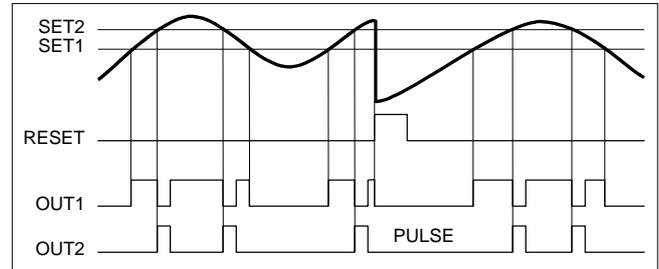
2. En la configuración LATCH1 el relé desactivado vuelve a activarse, si corresponde, cuando cesa la condición de activación del relé que efectúa la acción.
