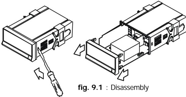
fig. 9.1 : Disassembly
