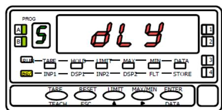
Un à l'étape précédente, il fait clignoter un chiffre (entre 1 et 4 selon la programmation précédente) sur l'afficheur [**1** = délai 30ms, **2** = délai 60ms **3** = délai 100ms **4** = délai 300ms]
