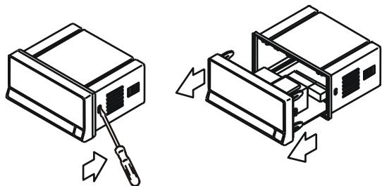
Extraer el conjunto electrónico de la caja y romper las uniones de la zona gris de la figura para separarla de la caja.
