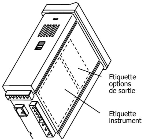
Vue arrière de l'instrument de base avec option de sortie RS485
