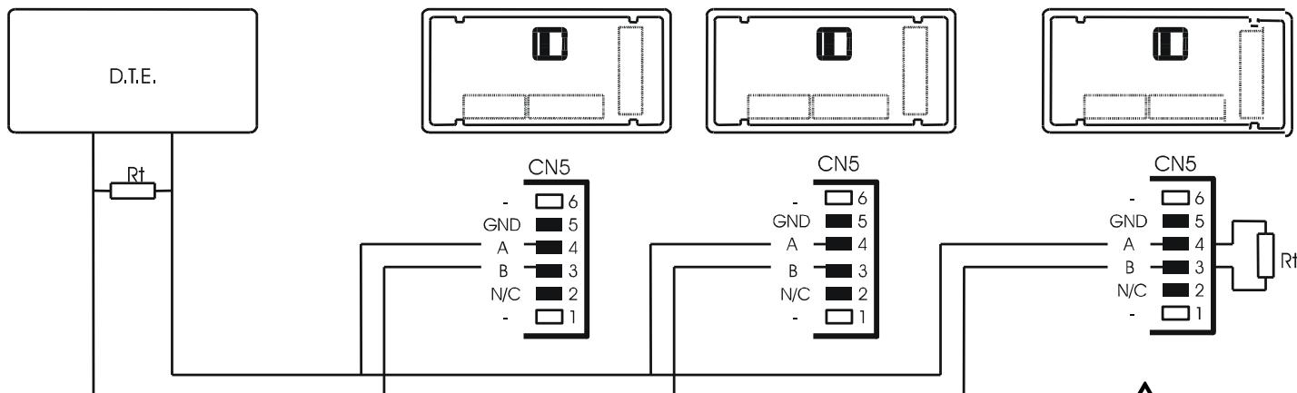
Hasta 31 indicadores DITEL pueden ser conectados en la misma línea con un D.T.E. mediante asignación a cada uno de ellos de una dirección única entre 00 y 99. La dirección 00 es común a todos los instrumentos de la línea y puede ser utilizada por el dispositivo maestro para dar una orden de tara del display, puesta a cero de las memorias o modificación de los puntos de consigna, es decir, aquellas que no implican la devolución de un valor por parte del aparato interrogado.
