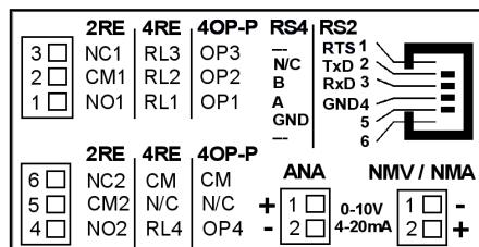
Cada tarjeta de salidas se suministra con una etiqueta adhesiva en la que se indica el conexionado de cada una de las opciones.
