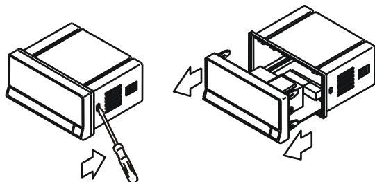
Extrayez l'ensemble électronique du boîtier et cassez les joints dans la zone grise de la figure pour le séparer du boîtier.
